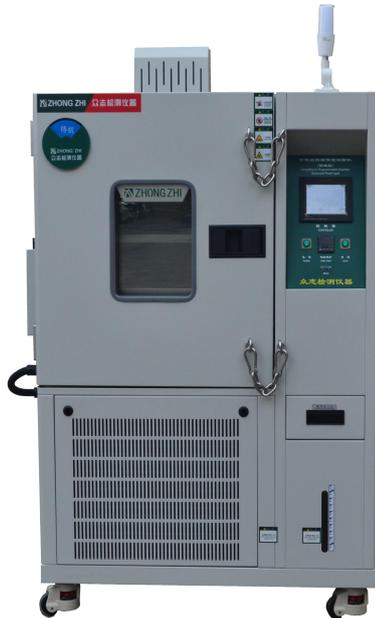
恒温恒湿试验箱加湿功能的优缺点一般来说有这四种方式:喷雾加湿、蒸汽加湿、浅水碟式加湿、过冷蒸汽加湿来实现相对湿度。
