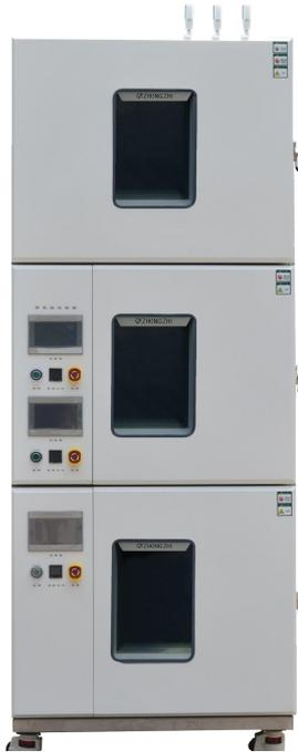
1、高低温试验设备。在高温试验中，如果温度变化达不到试验温度值，可以对电气系统进行检查，逐个排除故障。如果温度上升缓慢，检查空气循环系统，看看空气循环的风门是否正常打开。否则，检查电机的空气循环手术是否正常。如果温度超调严重，需要设置 PID 整定参数，如果温度直接升高，保护超温，如果控制器失效，须更换控制仪表。
