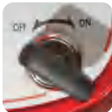
先关闭船型开关或 钥匙开关的电源
