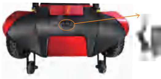
然后将代步车尾部充电 座防尘盖旋转打开，最 后将电插头插入车头充 电座内
